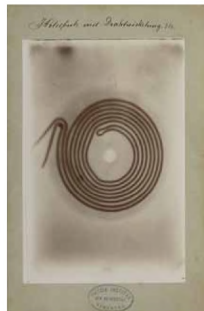
Figuur 6. Röntgenfoto van een houten klos met elektriciteitsdraad gefotografeerd door de houten zijanten van de klos heen. Deze foto toont aan dat hout de röntgenstralen vrijwel niet verzwakt.
