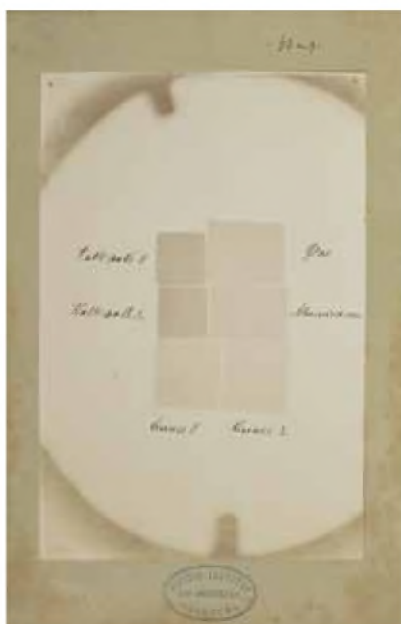
Figuur 10. Röntgenfoto van glas, aluminium en mineralen als kalkspaat ( \text{CaCO}_3 ) en kwarts ( \text{SiO}_2 ). Deze foto toont aan dat kalkspaat de röntgenstralen het minst doorlaat.
